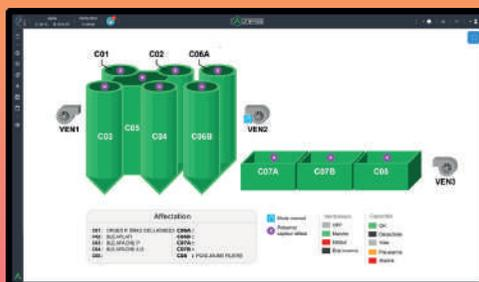
La supervision dédiée à la thermométrie des silos ! Contrôlez et agissez sur la température de vos cellules.
